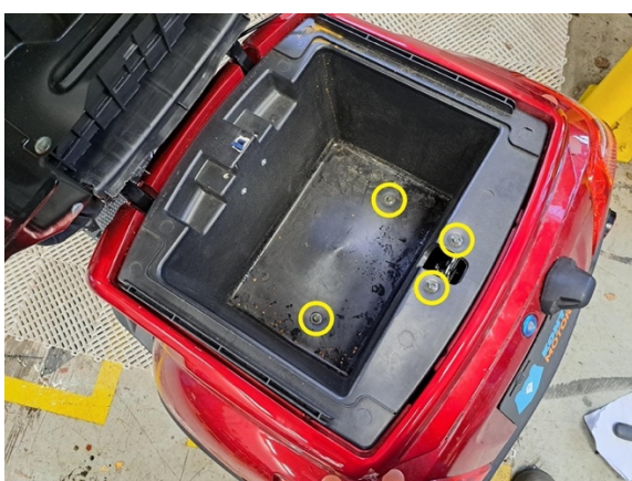
Irrota säilytyslokeron kiinnityspultit. (hylsy 8 mm).
